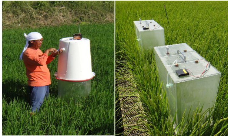
Hình 1.3. Thiết bị đo khí nhà kính cho lúa tại Nhật Bản
