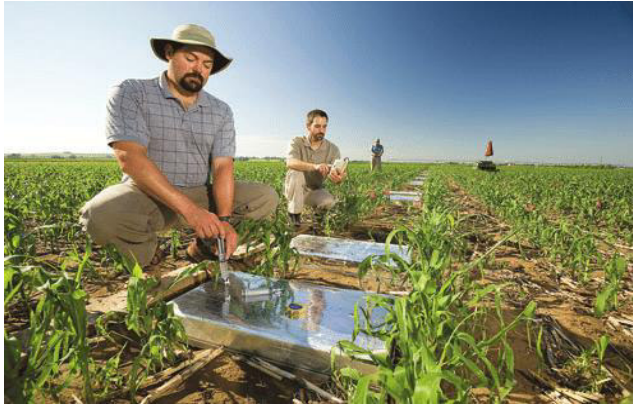
Hình 1. 5. Kỹ thuật đo lượng khí thải nhà kính từ đất trong một cánh đồng cao lương tại Ft Collins, Colorado, Mỹ
