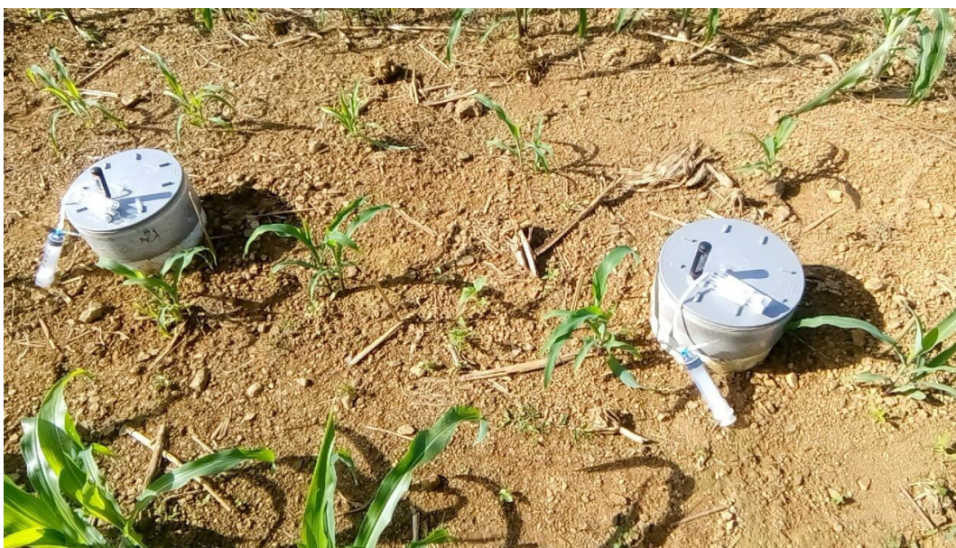
Hình 2. 3. Hộp đo khí và các phụ kiện phục vụ quan trắc khí phát thải từ canh tác ngô
