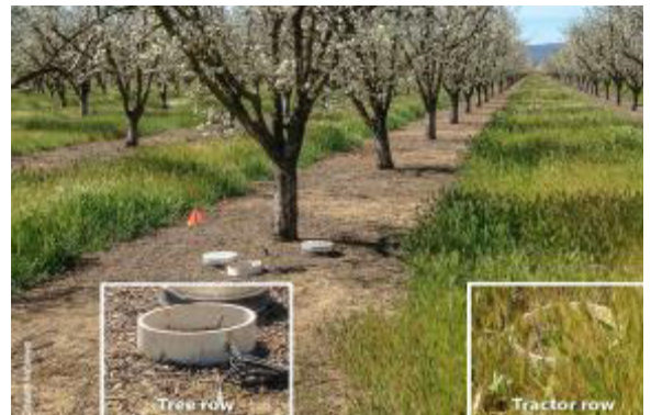
Hình 1. 8. Quan trắc phát thải qua các hộp đo khí thủ công tại vườn mận ở các vị trí khác nhau. Tại California, Mỹ
