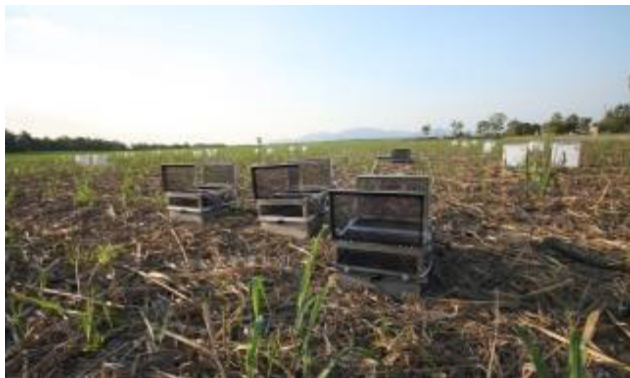
Hình 1. 7. Quan trắc phát thải khí nhà kính từ đất, sử dụng các kỹ thuật buồng tự động và thủ công trong trồng mía tại Ingham, Queensland, Australia
