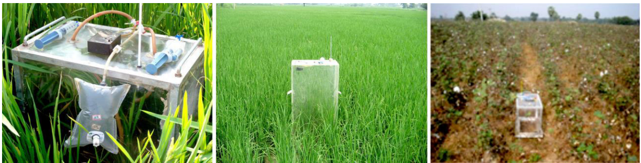
Hình 1.4. Thiết bị đo khí nhà kính cho lúa và cây trồng cạn tại Ấn Độ
