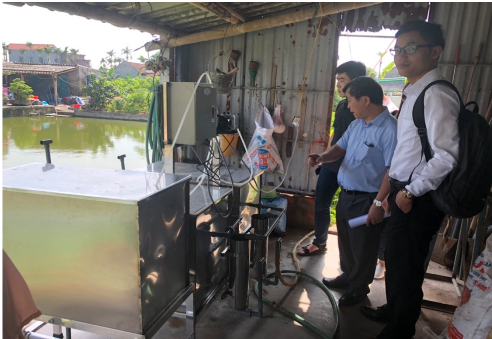
Hình 38 Hệ thống xử lý nước thải giàu chất hữu cơ, phục vụ quay vòng tái sử dụng trong sản xuất nông nghiệp
