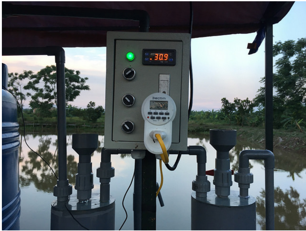
Hình 26 Mô hình thiết bị lên men yếm khí (đồng phân huỷ) 2m 3 đặt tại xã Lam Điền
