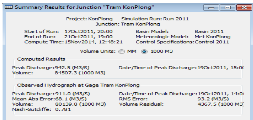
Hình 12: Kết quả tính toán dòng chảy tính toán và thực đo trạm lũ trạm Kon Plong (hiệu chỉnh mô hình)
