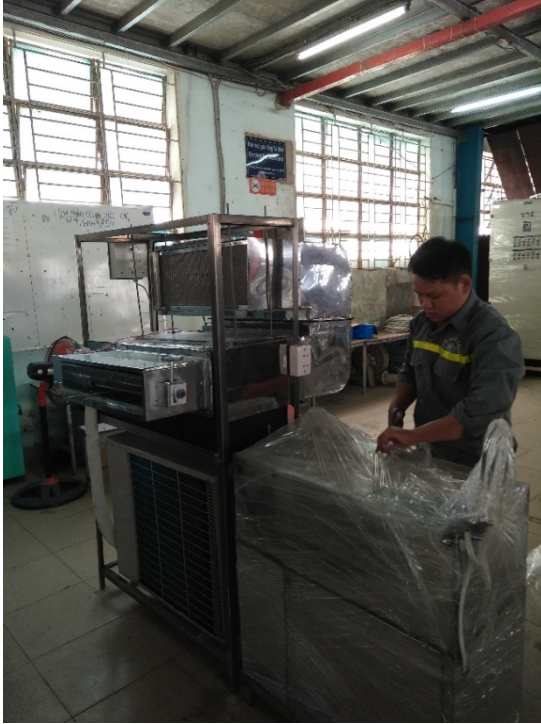
Hình 3.15: Tổng thể về hệ thống tách ẩm qui mô phòng thí nghiệm.
