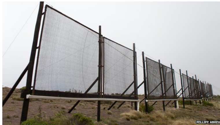
Hình 1.4: Những tấm lưới bẫy sương được lắp đặt trên núi ở Chile
