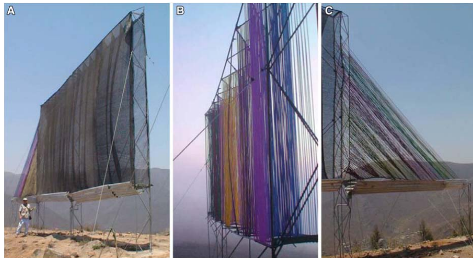
Hình 1.5: Hệ thống thu sương với các thiết kế thí điểm (a) Thiết kế Eiffel gồm hai lớp lưới Raschel (b) Thiết kế Harp với dây cao su dày 1,5mm (c) Thiết kế Diagonal Harp với dây cao su 1,5mm cột theo đường chéo
