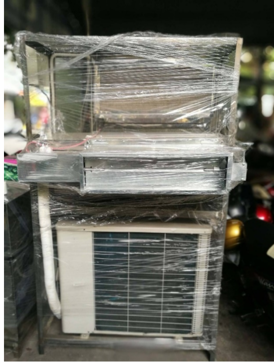
Hình 3.15: Tổng thể về hệ thống tách ẩm qui mô phòng thí nghiệm.
