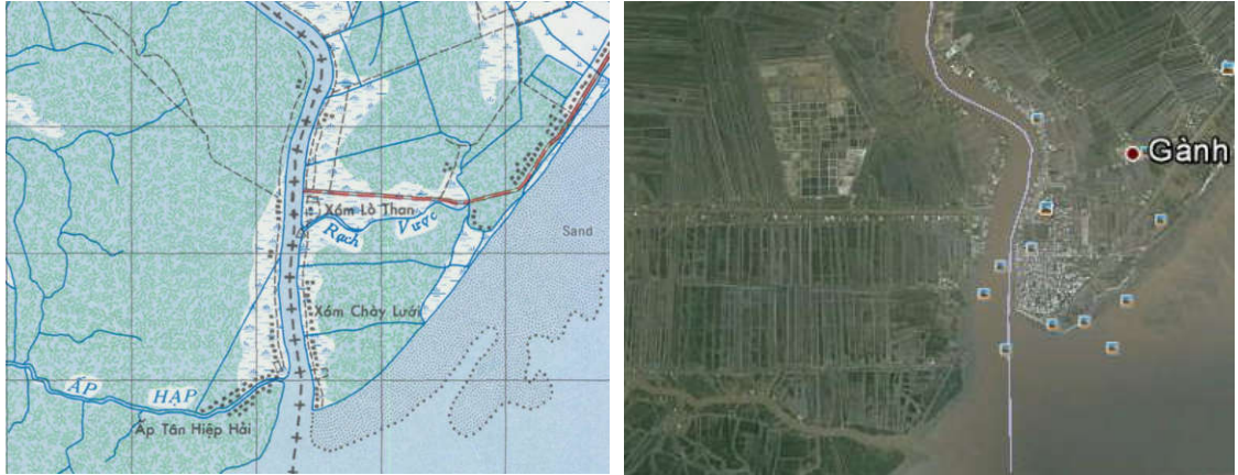
Hình 3.55. vị trí cửa Gành Hào vào năm 1965 (trái, nguồn: bản đồ địa hình UTM) và năm 2000 (phải, nguồn: Google Earth). Dễ dàng nhận thấy sông Áp Hạp vào năm 1965 còn chảy và sông Gành Hào, nhưng đến năm 2000, sông này đã đổ trực tiếp ra Biển Đông và cách cửa sông Gành Hào một đoạn dài về phía nam.
