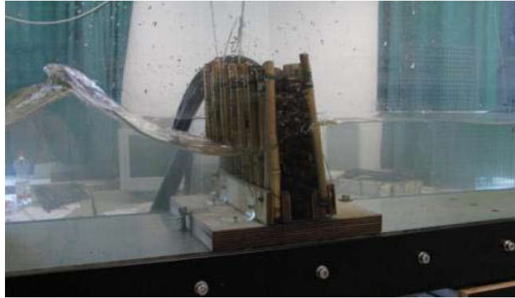
Hình 5.34. Mô hình vật lý truyền sóng qua hàng rào bằng tre [1]
