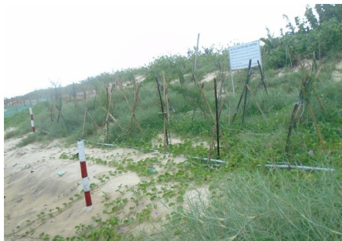
Hình 5. 62. Theo dõi biến động cát bay bằng cọc mốc quan trắc xã Cát Tiến – Phù Cát – Bình Định
