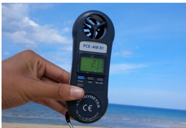
Hình 5. 60. Sử dụng máy đo gió cầm tay để hiệu quả giảm tốc độ gió của đai cây
