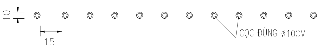
Hình 5. 94. Sơ đồ bố trí hàng rào để bẫy cát loại 2
