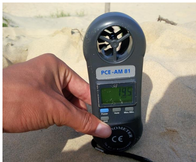
Hình 5. 65. Sử dụng máy đo gió cầm tay để hiệu quả giảm tốc độ gió của đai cây xã Cát Tiến – Phù Cát – Bình Định (Nguồn: Lê Ngọc Cương, 2015)
