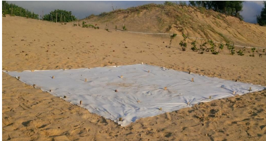
Hình 5. 34. Bố trí thí nghiệm sử dụng vải địa kỹ thuật tại xã Cát Tiến – Phù Cát – Bình Định
