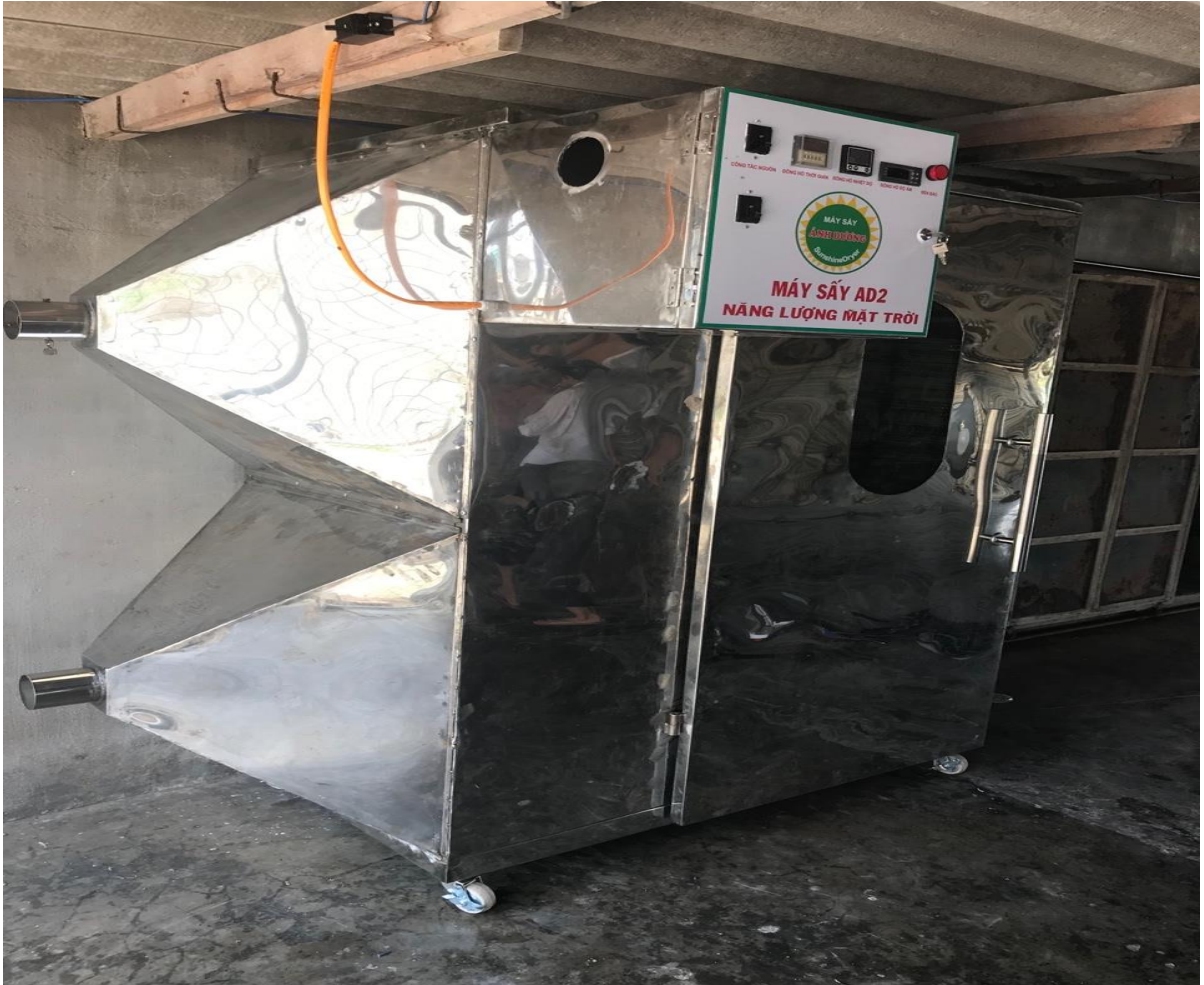
Hình 5. 30. Hệ thống sấy sử dụng năng lượng mặt trời đang trong quá trình lắp đặt
