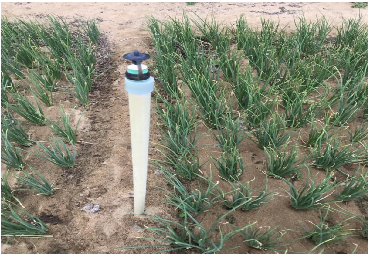
Hình 5. 19. Đầu ống tưới phun mưa
