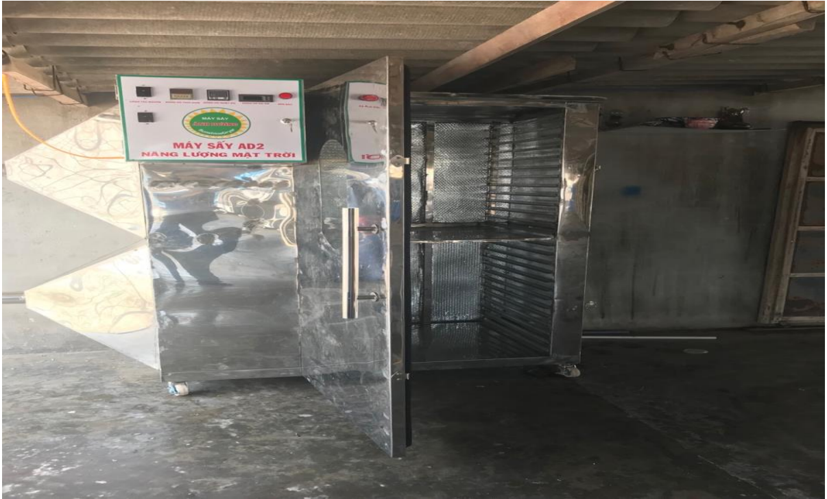
Hình 5. 34. Hệ thống sấy sau khi được lắp đặt hoàn chỉnh
