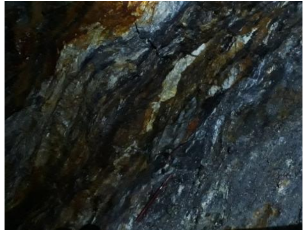
Hình 5.48: Cấu tạo mạch quặng sunfur chứa vàng trong lò I khu vực Nước Vin cho thấy cấu trúc mạch quặng nằm chính hợp trong phiến phức hệ Khâm Đức. Các ổ, thấu kính thạch anh, calcit đi cùng xuyên chính hợp phiến. Mạch quặng giàu graphit(màu đen)
