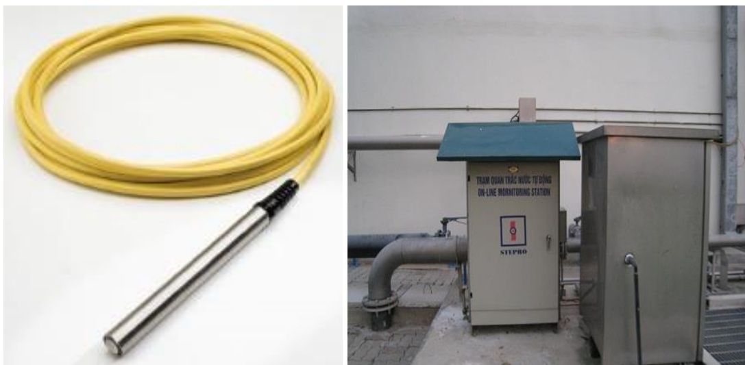
Hình 5.13. Sensor đo mực nước, Model: WL400, Hãng Global Water - Hoa Kỳ (trái) và trạm quan trắc nước và môi trường tự động scan
