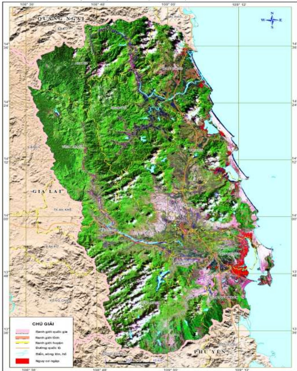
Hình 4. 4. Bản đồ nguy cơ ngập tỉnh Bình Định ứng với kịch bản NBD 80 cm
